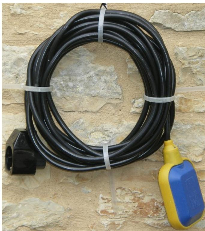
Le contacteur flottant de l'interrupteur de sécurité doit être à une dizaine de centimètres du fond, le câble bien tendu. Ce réglage est plus facile à faire citerne vide.
